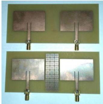
Gambar 8 Hasil Fabrikasi Antena Susun Tanpa EBG dan Antena Susun dengan Split Ring EBG
