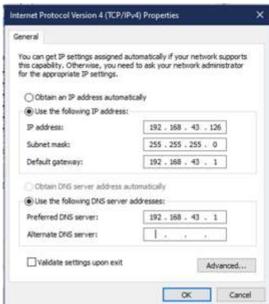
Gambar 11. Pengaturan IP Statik Windows 10
