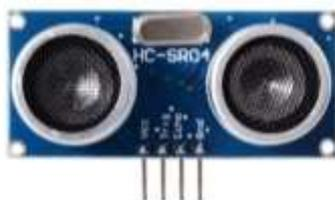
Gambar 2.4 Bentuk fisik sensor HC-SR04
