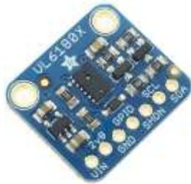
Gambar 2.2 Bentuk fisik sensor VL6180X
