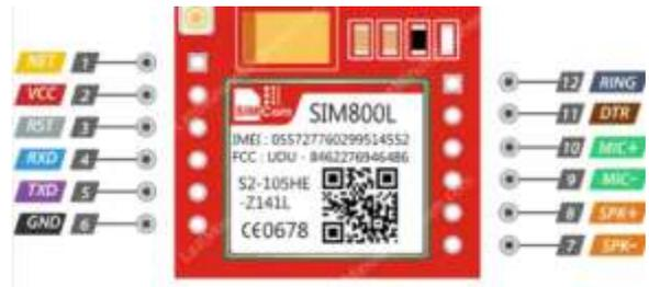
Gambar 10. GSM SIM800L
