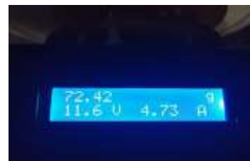
Gambar 24. Tampilan LCD Ketika Beban Biji Jagung Terdeteksi Sensor Berat
