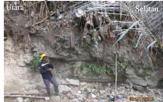
Gambar 5. Singkapan Satuan Batuan Batugamping Sisipan Batulempung. N 72° E/24° Dijumpai di lokasi pengamatan Kali Grinjingan Ed 04.
