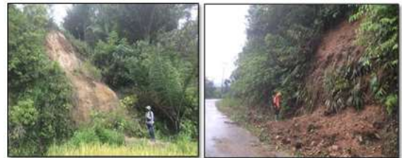
Gambar 25. Foto kenampakan gerakan tanah jenis debris fall AN – 24 dijumpai di daerah Tabek dan AN – 15 dijumpai di Jalan Talang Babungo
