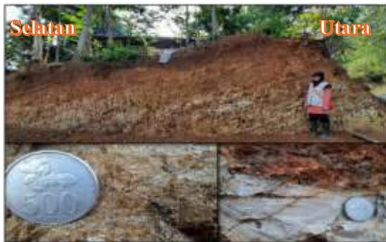
Gambar 19. Singkapan perselingan batupasir tufan dan tuf pada lokasi pengamatan LP-05 arah foto N 240° E.
