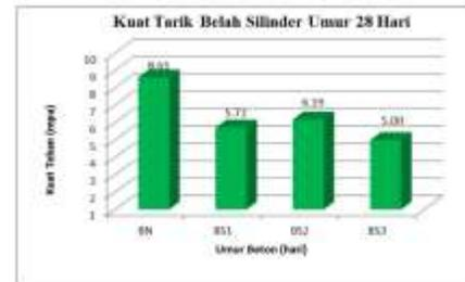
Gambar 9. Diagram hubungan antara kuat tarik beton dan variasi beton pada umur 28 hari
